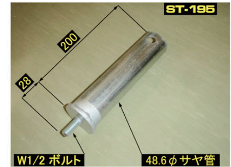
シーズ管ネジ込式サヤ管 ST-195 (パルコニー手摺支柱対応)
